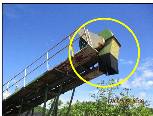
ภาพที่ 2.47 ผ้าใบปิดคลุมบริเวณปลายสายพานลำเลียงแร่
