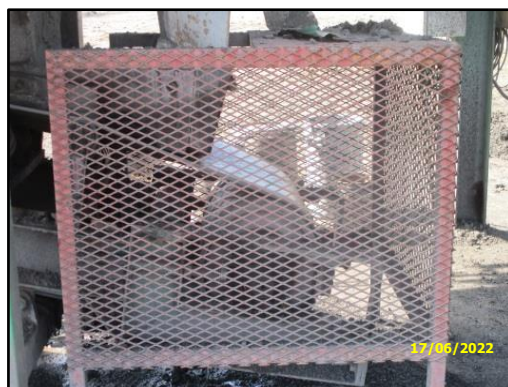
ภาพที่ 2.31 ตัวอย่างสายพานระบบปิด บริเวณที่มีเครื่องจักรเคลื่อนไหว
