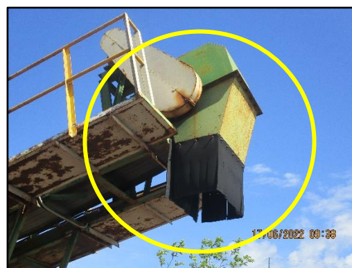
ภาพที่ 2.47 ผ้าใบปิดคลุมบริเวณปลายสายพานลำเลียงแร่
